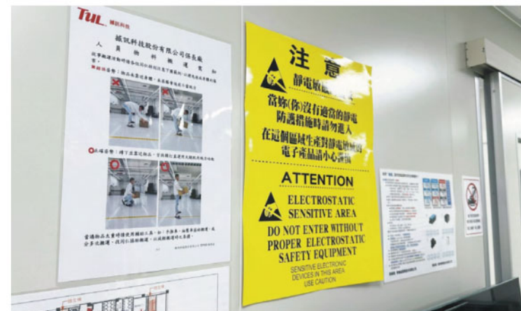
於廠區張貼重物搬運須知與靜電區域警示
